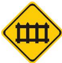
A-40 PASSAGEM DE NÍVEL COM BARREIRA
