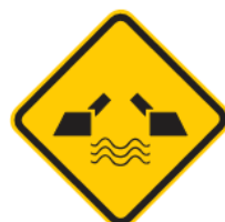
A-23 PONTE MÓVEL
