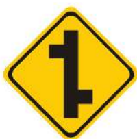
A-11b JUNÇÕES SUCESSIVAS CONTRÁRIAS 1ª À DIREITA
