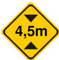
A-37 ALTURA LIMITADA
