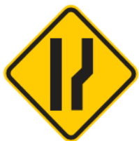
A-21e ALARGAMENTO DE PISTA À DIREITA
